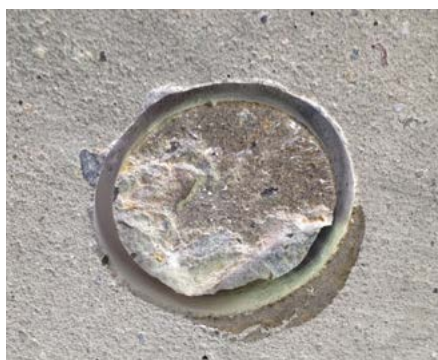
▲ Test de la force d'adhérence sur le support sablé
