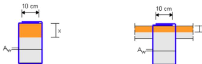
L'ancrage des tissus peut également être réalisé à l'aide des mèches d'ancrage S&P C-Anchor (voir chapitre 2.4.5.3) ou pièces d'ancrage métalliques (voir chapitre 2.4.5.2) comme représenté ci-dessous.
